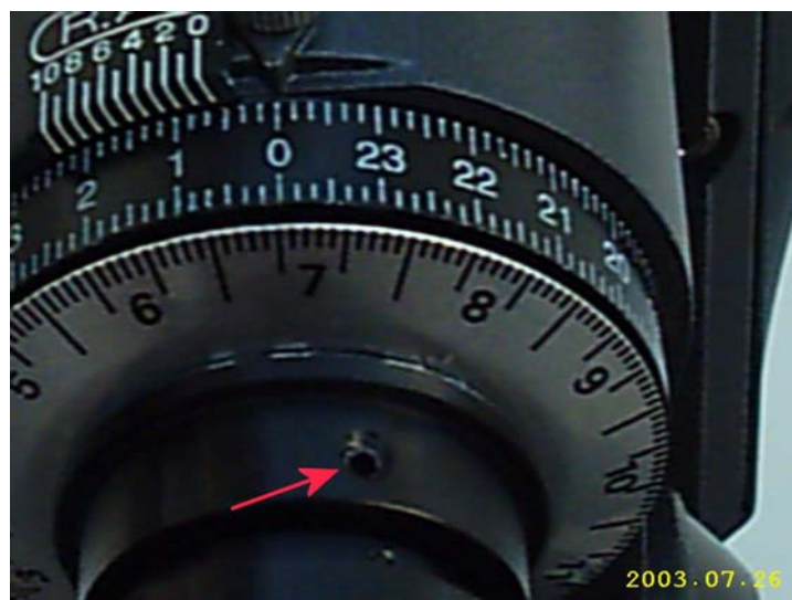
Viti per l'allineamento del cannocchiale polare.
